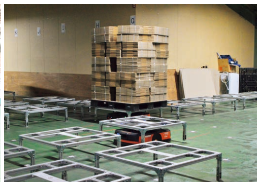
AGV(無人搬送車)が自動で 出荷先ごとに 商品を仕分けする
